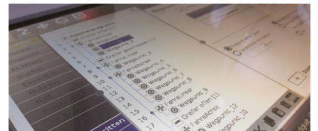
Der Roboter kann über ein beigefügtes Tablet einfach programmiert werden
